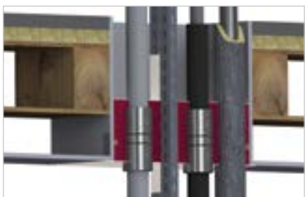
Walraven Pacifyre® und Tangit Sonderanwendung Holzbalkendecke
