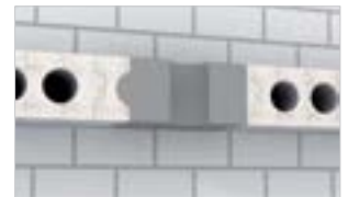
Porenbetondecke (ggf. mit Hohlkammern)
