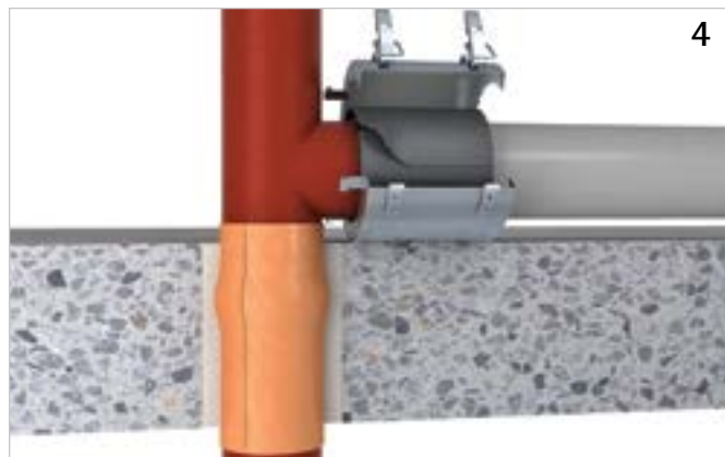
Blechgehäuse der Walraven Pacifyre® KonFix Hülse öffnen, bündig um das Band legen, Laschen schließen und mit dem Metallspannband fest am Rohr fixieren.
