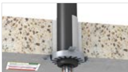
Pythonleitungen (Getränkeleitungen) ggf. mit Schutzrohr
