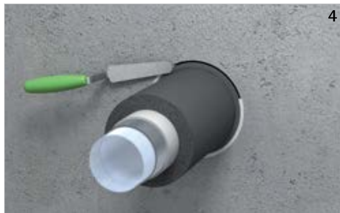
Rest- bzw. Ringspalt rauchgasdicht (mit z. B. Walraven Pacifyre® FPM Brandschutzmörtel) verschließen.
